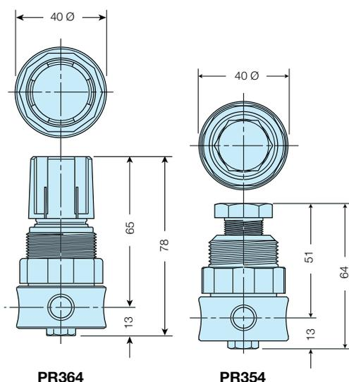
**Hinweis:** Eine Bohrung von 32 mm wird beim Einbau für die Schalttafelmutter benötigt.
