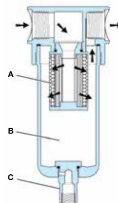
Die verschmutzte Luft kommt in das Innere des Elements und muss eine dicke Membran (A) aus Borosilikatglasfasern mit Epoxidharz passieren. Ein Fluss (Flow) gelangt dann durch das Element und zu diesem Zeitpunkt sind 99,97% der kleinsten Partikel aus dem Luftstrom entfernt. Die kleinen Tropfen verbinden sich und sammeln sich im Filterelement.
